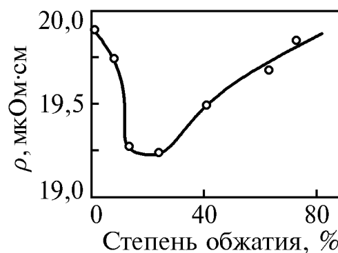
Рис. 5.20. Изменение удельного электрического сопротивления стали, содержащей 0,3% углерода, при пластической деформации
