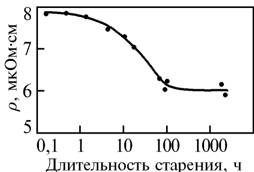
Рис. 5.24. Зависимость удельного электрического сопротивления сплава АМг8 от длительности старения при 150 °С
