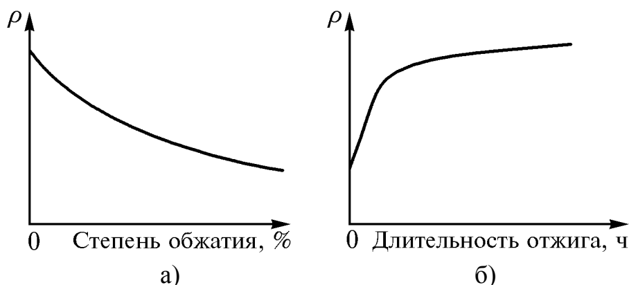
Рис. 5.14. Схема изменения удельного электросопротивления нихрома (80% Ni, 20% Cr) при пластической деформации (а) и последующем отжиге (б)
